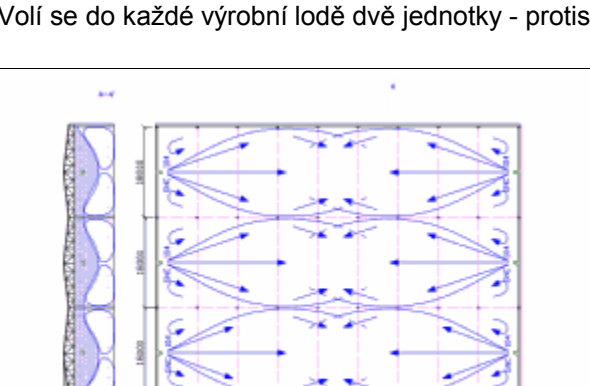
Obr. č. 9 - Příklad návrhu teplovzdušného vytápění velkými jednotkami s bezpotrubním vypouštěním vzduchu do vytápěného prostoru. (po kliknutí se obrázek zvětší)
