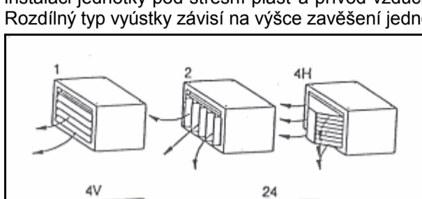
Obr. č. 1 - Výustky pro instalaci na jednotky GNS s axiálními ventilátory. 1 - výustka s vodorovnými lamelami, 2 - výustka se svislými lamelami, 4H - výustka 2 x 45° s vodorovnými lamelami, 4V - výustka 2 x 45° se svislými lamelami, 24 - výustka podstrojní 45° bez lamel
